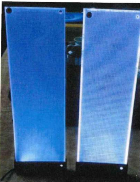
【試作した金型による導光板(左:均一な発光)】
